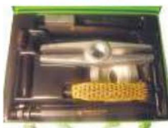
Set per l'estrazione di cuscinetti con vite idraulica
